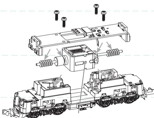
MOTORKERBE UND BOHRUNG NACH VORNE
