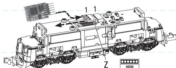
**Einbau eines digitalen Empfängerbausteins:**
