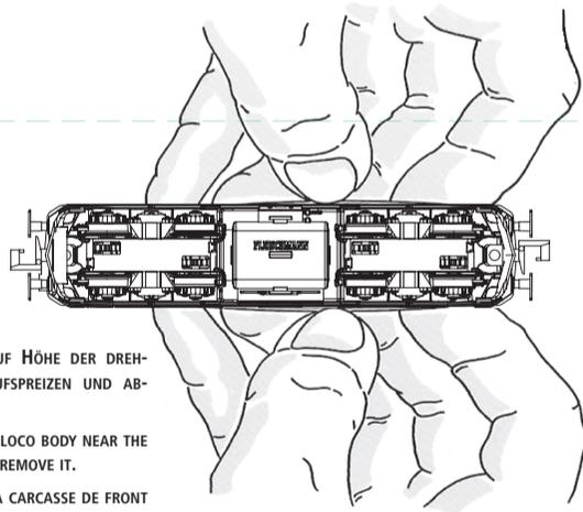
GEHÄUSE AUF HÖHE DER DREHGESTELLE AUFSPREIZEN UND ABZIEHEN.
